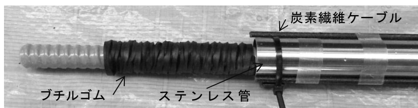
図-8 補強材の組み立て写真（地表側）
