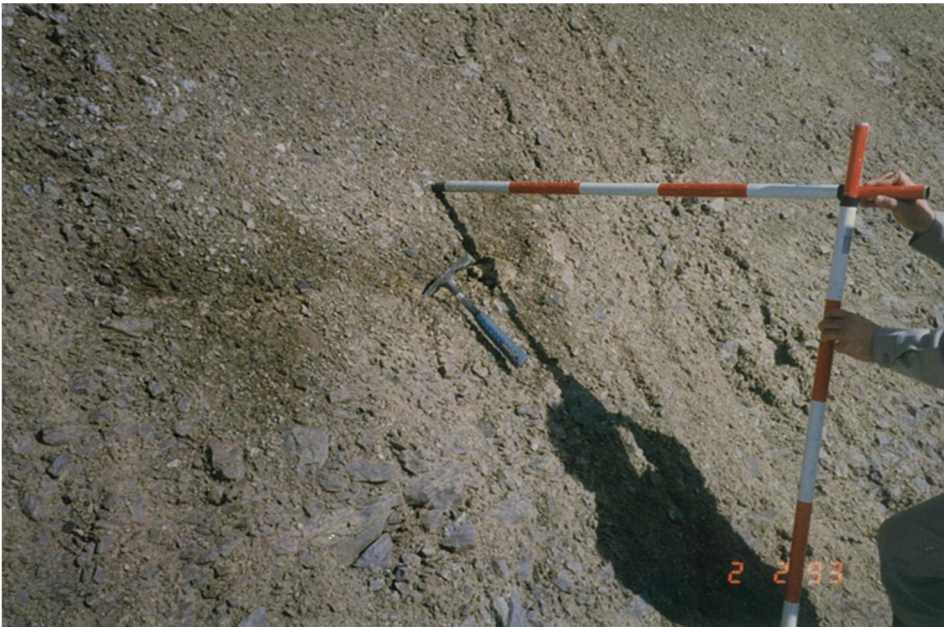
湧水箇所には高含水比の粘土がある。条線を有するすべり面は確認不能であるが、粘土薄層があったため、すべり面と推定した。
