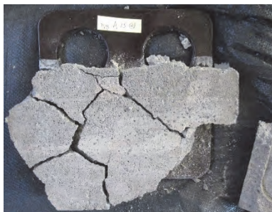
実験 セットハンマー15回の打撃でモルタルは割れ27回打撃でも離れない。地質ハンマー打撃では分離しない。
