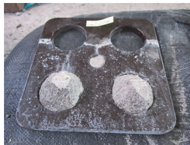
実験 セットハンマー15回の打撃でモルタルは割れ27回打撃でも離れない。地質ハンマー打撃では分離しない。
