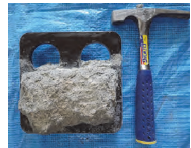
実験 セットハンマー15回の打撃でモルタルは割れ27回打撃でも離れない。地質ハンマー打撃では分離しない。
