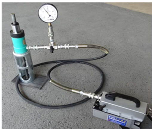
図-4.14 ジャッキとバッテリーポンプ 20回使用可能 予備バッテリー有り
