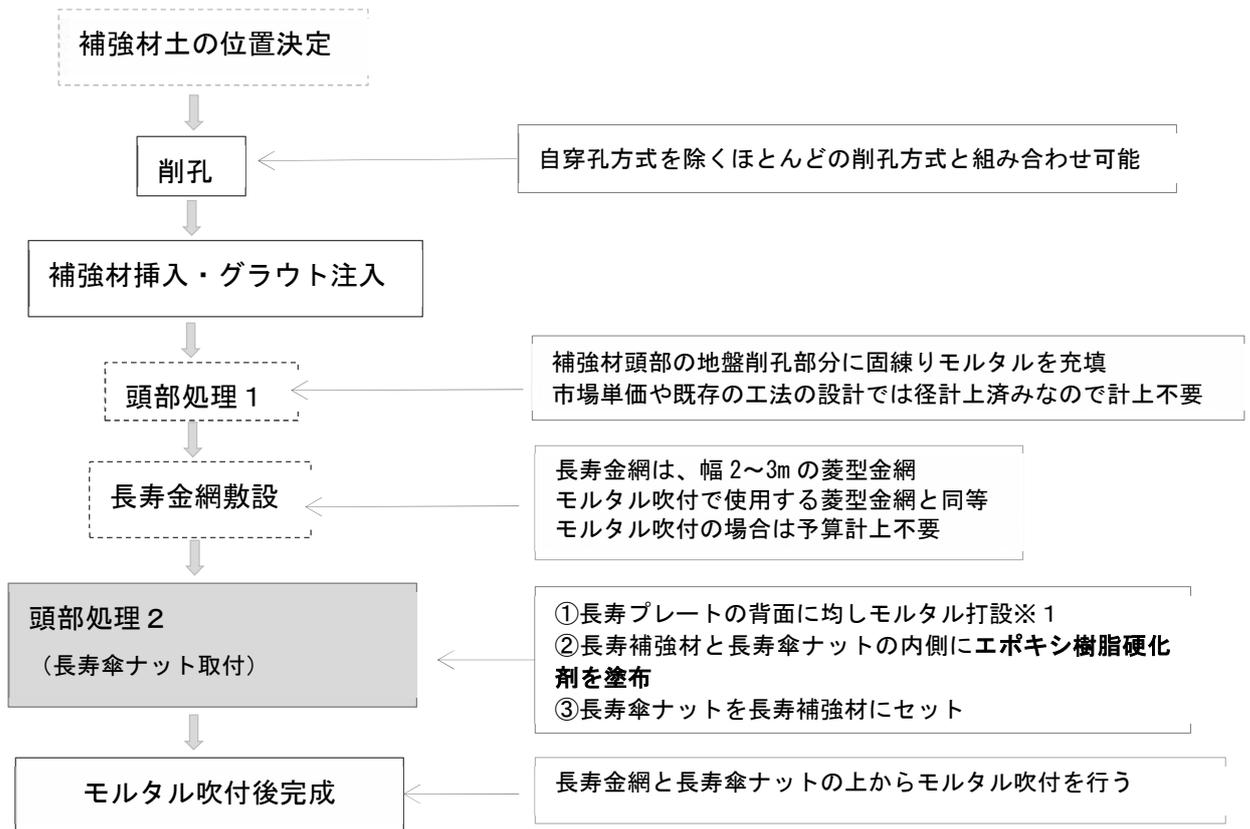
図-4 施工フローチャート (参考例)
