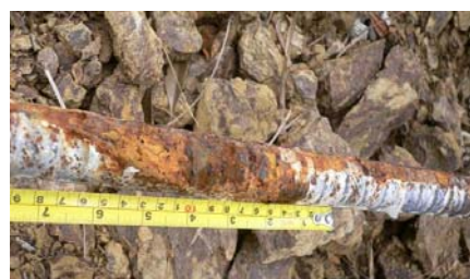
崩壊によると思われる腐食例(建設後17年経過) 白い部分はセメントミルク付着痕 無メッキ補強材
