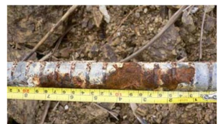
崩壊によると思われる腐食例(建設後17年経過) 白い部分はセメントミルク付着痕 無メッキ補強材
