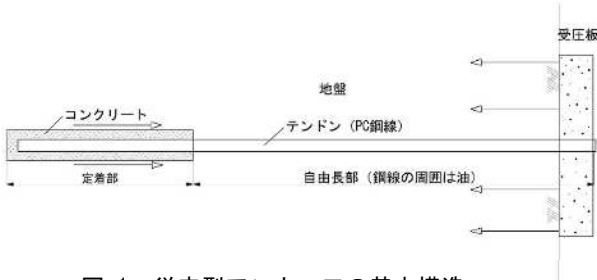
図-1 従来型アンカー工の基本構造
