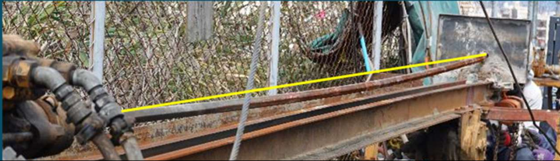
削孔機材の曲がり事例 ツールが真っ直ぐでも 硬質な礫や地層で孔曲がり frequently 発生
