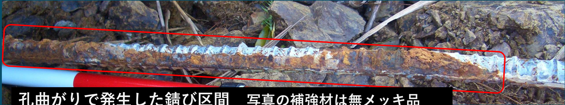
削孔機材の曲がり事例 ツールが真っ直ぐでも 硬質な礫や地層で孔曲がり frequently 発生
