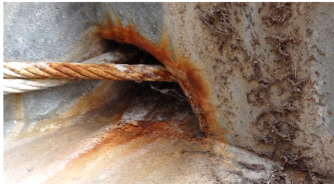
図-7 酸性水で錆びたメッキ品
