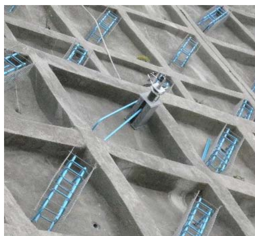
図-4.8 LLホルダーを内蔵するラムチェア一般のセンターホールジャッキで試験可能
