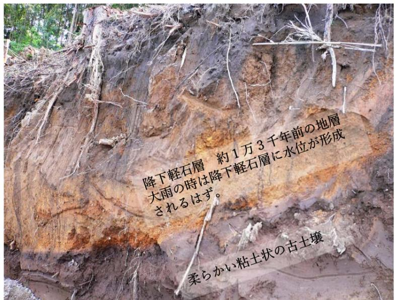
現場法面の一部には、アンカー工を施工している。埋没谷地形に沿って、降下軽石層が分布し、斜面上部には馬蹄形の滑落崖があったからだ。大雨の際に、この降下軽石層に地下水が集まり、浮力が掛かるであろう。珍しいケースだ。この露頭で、なぜ、稀にみる程度まで風化が進んでいたか理由が解った。この斜面は、一万三千年以上前から風化が進んでいるのだ。どおりで、円弧型の崩壊もするし、N値もゼロの区間が多いはずだ。
