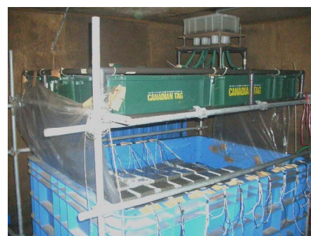
写真-3 酸性雨劣化促進試験装置
