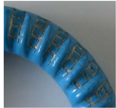
写真-3.2 碁盤目試験状況
